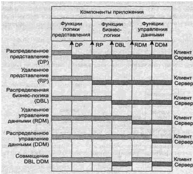
Рис. 32. Распределение функций приложения в моделях «клиент-сервер»
