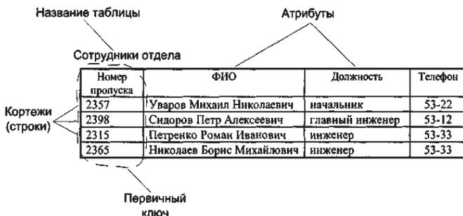
Рис. 3. Отношение реляционной БД
