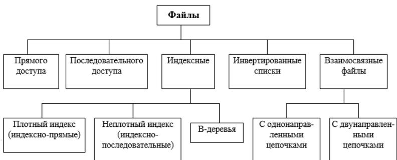
Рис. 20. Классификация файлов, используемых в системах баз данных
